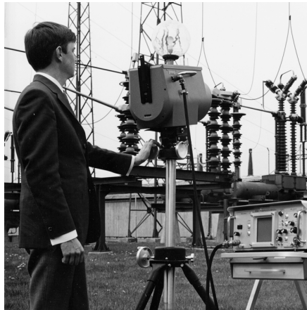
1969: Thermovision 661. modell. A kamera tömege körülbelül 25 kg, az oszcilloszkóp tömege 20 kg, az állvány tömege pedig 15 kg. A kezelőnek szüksége volt egy 220 V AC generátorra, valamint egy 10 literes, folyékony nitrogént tartalmazó palackra. Az oszcilloszkóp bal oldalán egy Polaroid tartozék (6 kg) látható.
