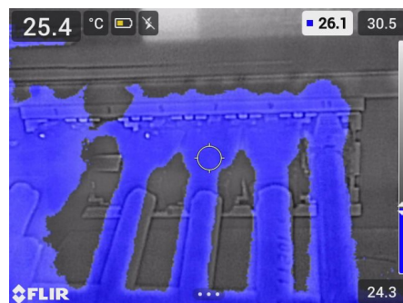
Meghatározott érték alatti riasztás: Az összes olyan képpontot kiemeli, amelynek hőmérséklete a megadott hőmérsékleti szint alatt van.
